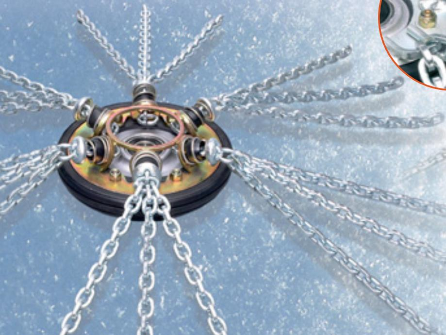
**Цепное колесо с 12 отдельными цепями, диаметром 195мм**
